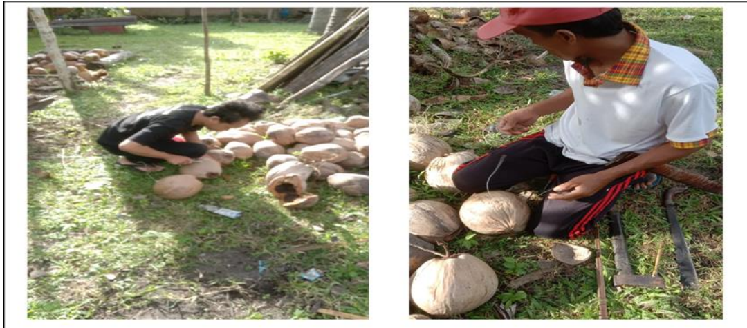
Gambar 8. Pembuatan lobang untuk tali pelampung
